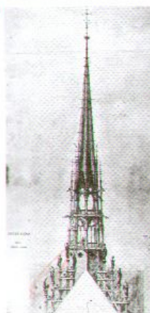
FIGURE 10-11 • Parigi. Notre-Dame, progetto della guglia centrale (29 ottobre 1857, Centre de Recherches des Monuments Historiques, Parigi) e dettaglio all'incrocio del transetto. Con la rivoluzione del 1789 la cattedrale subisce gravi danni e solo dopo il 1815 si può pensare al suo restauro che si comincia a concretizzare nel 1845 per concludersi diciannove anni dopo. Tra i lavori è prevista anche la ricostruzione della guglia centrale che sviluppa novantasei metri di altezza. Essa è posta all'incrocio delle coperture delle navate e del transetto; un punto sottolineato anche dalle figure scultoree che Viollet-le-Duc scaglionava lungo le linee d'intersezione (da AA.VV., 1981a).
